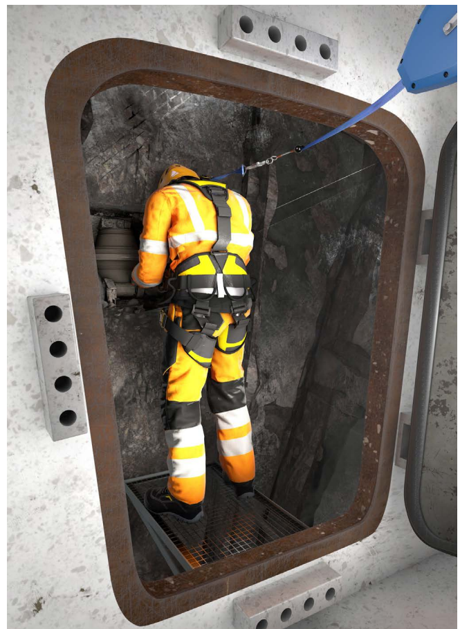
Abb. 8 Durchführen des Werkzeugwechsels im oberen Schildquerschnitt
